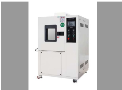
▲ تجهیز ازن جهت آزمون کهنگی عایق و روکش
