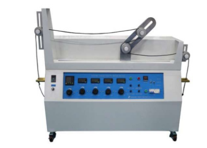
تجهیز انعطاف پذیری جهت آزمون انعطاف کابل های انعطاف پذیر
