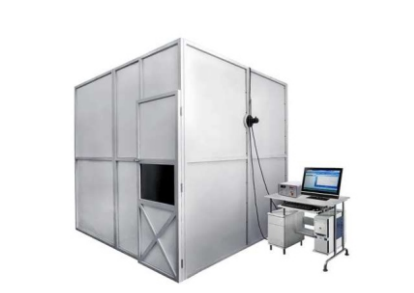
▲ تجهیز اتاق دود جهت اندازه گیری چگالی دود ناشی از سوختن کابل
