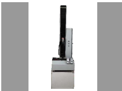
▲ تجهیز تنسایل جهت آزمون استقامت کششی
