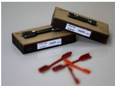
▲ تجهیز تیغه جهت آماده سازی نمونه های دمبلی
